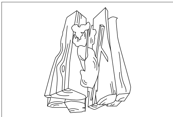
Figur 5. Rätt fyllning med ved.
