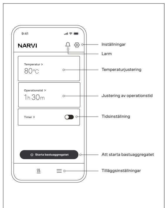
Bild 8.1-1. Användning av mobilappen
