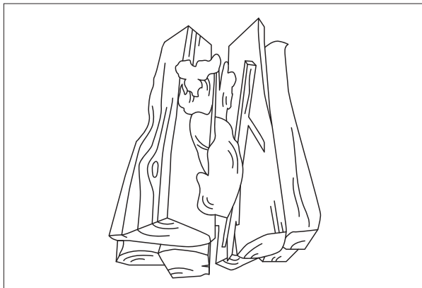
Kuva 9. Kuva puiden oikeanlaisesta latomisesta.
